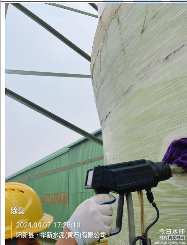
RDF 除臭排气筒采样口◎10
