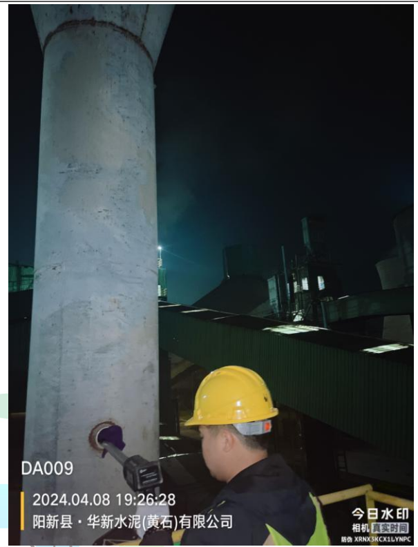
DA009 辅助原料破碎及输送排气筒采样口◎8
